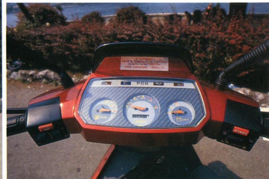
*In alto, il P.G.O. Star 50 durante la nostra prova su strada; a sinistra, una veduta frontale dello scooter di Taiwan; sopra, la strumentazione, che comprende tachimetro, contachilometri, voltmetro, spie di minimo olio e accensione luci e indicatore del livello della benzina: una dotazione veramente completa*
